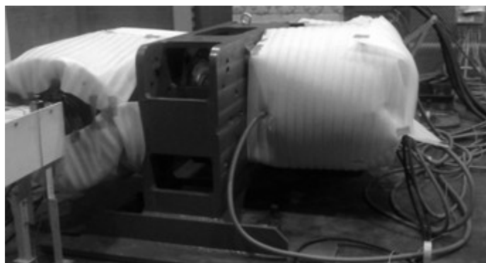
Rys. 34.5 Sposób ograniczenia wymiany ciepła korpusu badanej przekładni
