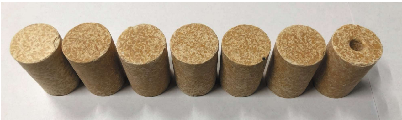
Rys. 5 Cylindryczne próbki trotylu Fig. 5. Cylindrical TNT samples
