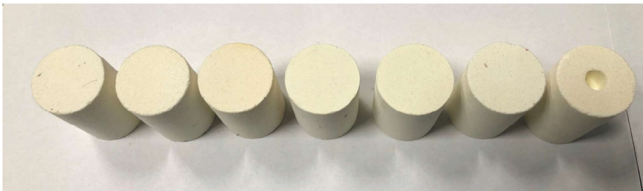
Rys. 3. Cylindryczne próbki oktogenu flegmatyzowanego Fig. 3. Cylindrical phlegmatized HMX samples
