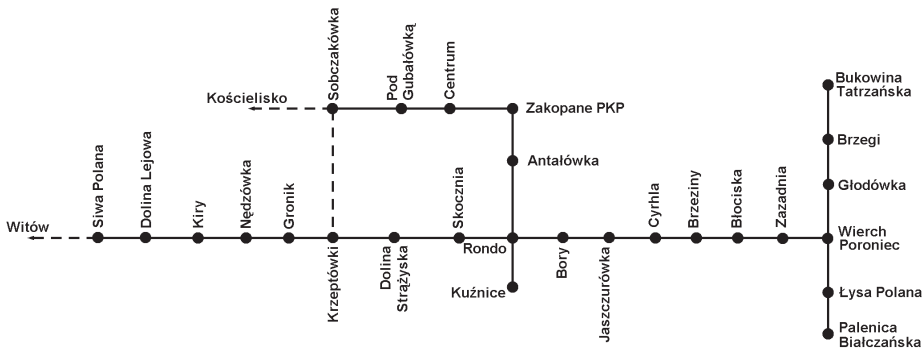
Rys. 1. Schematyczny przebieg tras i lokalizacja przystanków dla koncepcji tatrzańskiej kolei turystycznej. Liniami przerywanymi zaznaczono możliwości rozbudowy sieci w dalszych etapach
