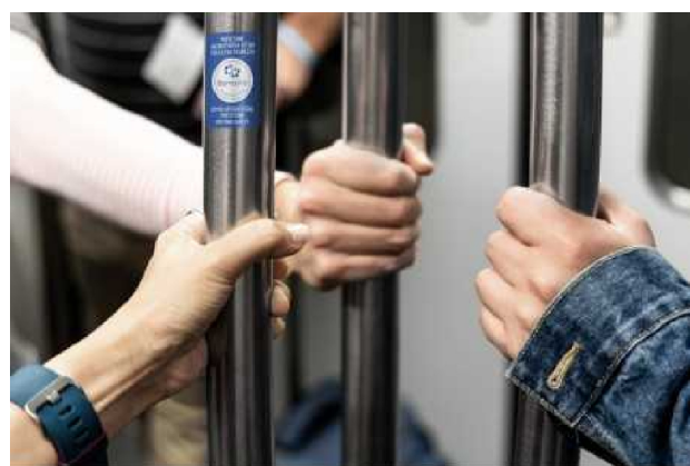
Rys. 8. Poręcze w wagonie pokryte folią antibakteryjną [26]
