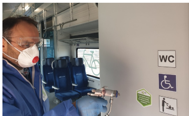
Rys. 6. Nanoszenie powłoki antybakteryjnej na ściany wagonu [13]
