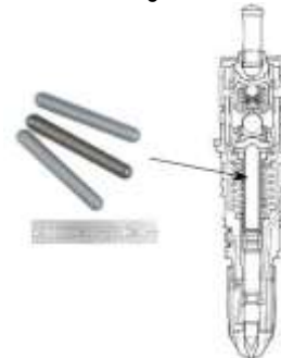
Rys. 5. Wtryskiwacz UIS Cummins i wykonany z Si 3 N 4 łącznik [8]
