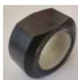
Rys. 8. Krzywka z napyloną warstwą ceramiczną na tulei ślizgowej
