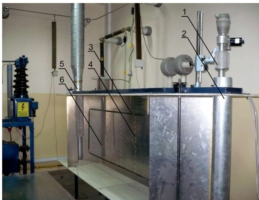
Rys. 4. Widok elektrofiltru laboratoryjnego ze zdjętą elektrodą zbiorczą 1 – podajnik pyłu, 2 – dyfuzor, 3 – rama nośna elektrod ulotowych, 4 – elektroda ulotowa, 5 – konfuzor, 6 – elektroda zbiorcza
