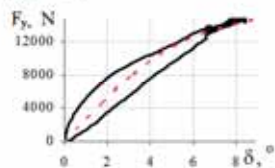
Rys. 4. Nabieganie ogumienia w warunkach oscylacyjnych zmian wartości kąta znoszenia koła; a) oscylacje kąta znoszenia koła \delta wokół zerowej wartości z różnymi amplitudami ( f = 2 \text{ Hz} ); b) oscylacje kąta znoszenia koła \delta wokół zadanej wstępnie jego wartości ( f = 2 \text{ Hz} , A = 1^\circ , v_x = 60 \text{ km/h} )
