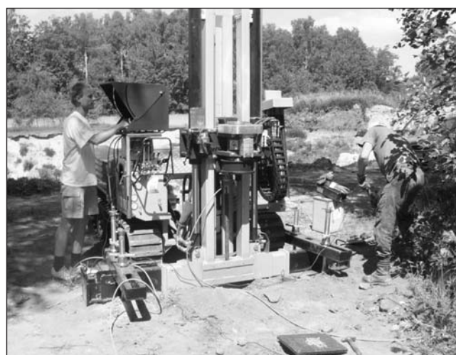
Fig. 3. Penetrometr Geotech 220-04 z zestawem SCPT (na zdjęciu moment generacji fali poprzecznej)
