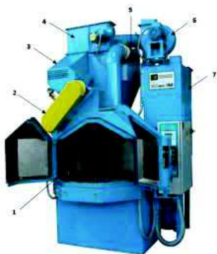
Rys. 9. Oczyszczarka stołowa typu T10 firmy CM z otwartą komorą roboczą i widocznym wyłożeniem blachami ze stali manganowej [14]: 1 – komora robocza, 2 – wirnik rzutowy, 3 – separator śrutu, 4 – podajnik pionowy, 5 – cyklon, 6 – wentylator ssący, 7 – filtr powietrza
