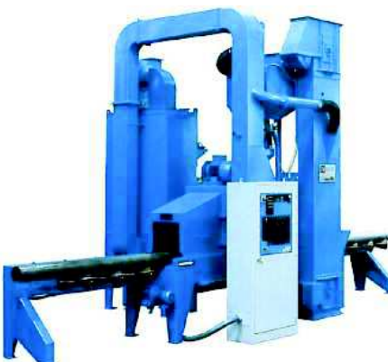
Rys. 20. Oczyszczarka strumieniowa typu Diabolo SCT [14]
