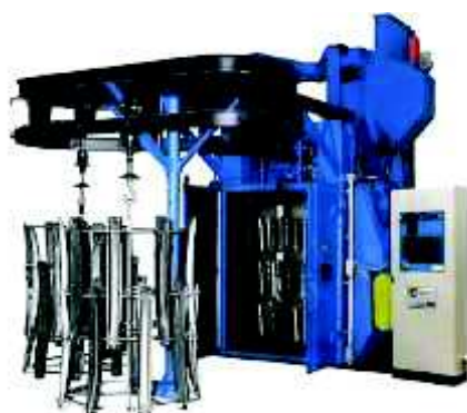
Rys. 17. Oczyszczarka wirnikowa typu M zawieszkowa nieprzelotowa [14]
