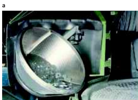
Rys. 16. Oczyszczarki wirnikowe stołowe z obrotowymi pojemnikami do obróbki drobnych detali: a) [14], b) [17]
