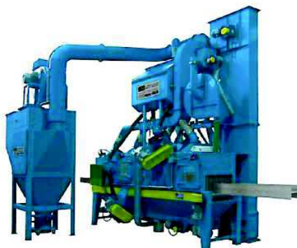
Rys. 19. Oczyszczarka strumieniowa przelotowa typu SP do obróbki kształtowników [14]
