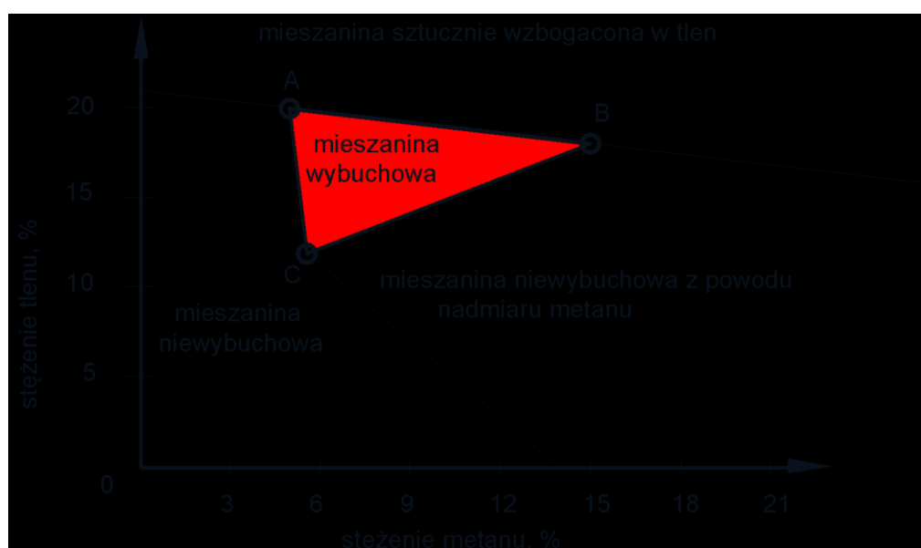
Rys. 2. Trójkąt wybuchowości Cowarda dla metanu
