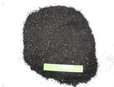
Rys. 3.5. Masa anodowo- katodowa przeznaczona do prób hydrometalurgicznych klasa ziarnowa < 3\text{mm}
