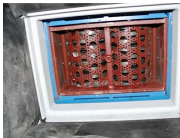
Rys.3.4 Rozdrabniacz AZ05F Wichary z zamontowanym sitem \varnothing 22
