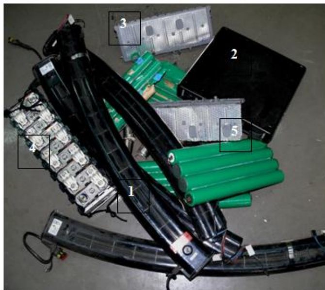
Rys. 3.1. Akumulatory i ogniwa NiMH wykorzystane w próbie mechanicznego rozdrabnianiania.
