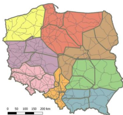
Rys. 6. Zasięg obszarów sterowania RCSów w koncepcji scentralizowanego systemu kierowania i sterowania ruchem kolejowym o zasięgu krajowym. [4]
