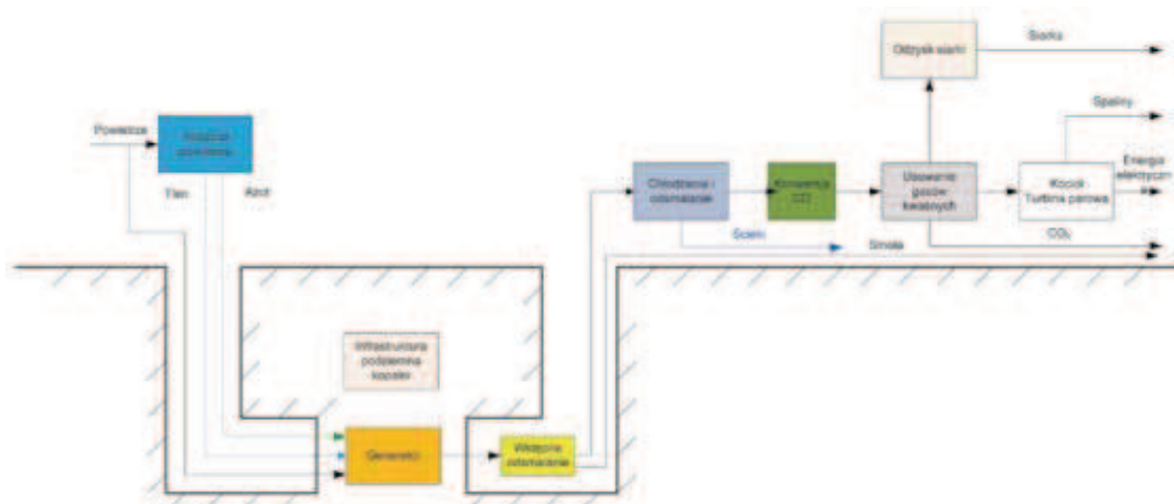
Rys. 1. Schemat podziemnego zgazowania węgla metodą szybową [15]
