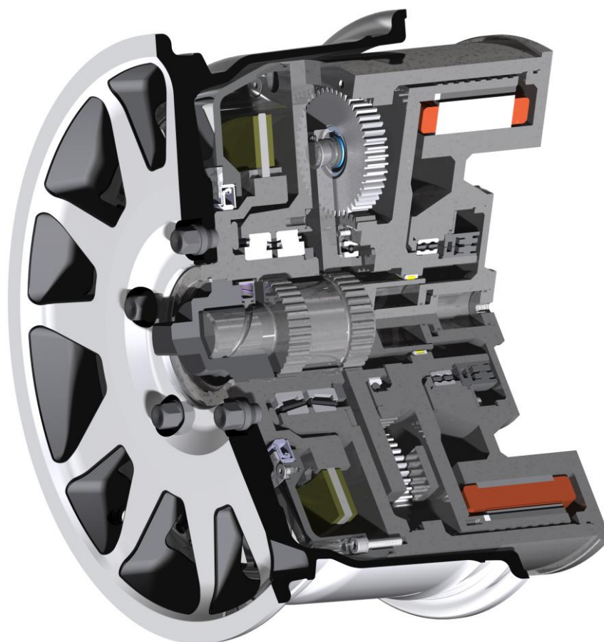
Rys. 2. Model 3D napędu z układem mechanicznym przełączania zazębienia
