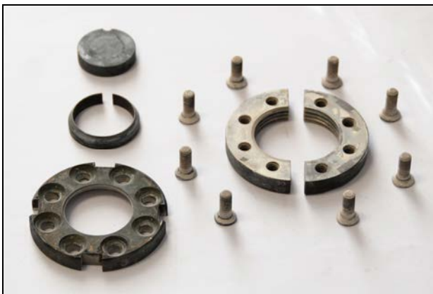
Rys. 5. Fotografia elementów mocujących próbkę (tarczę)
