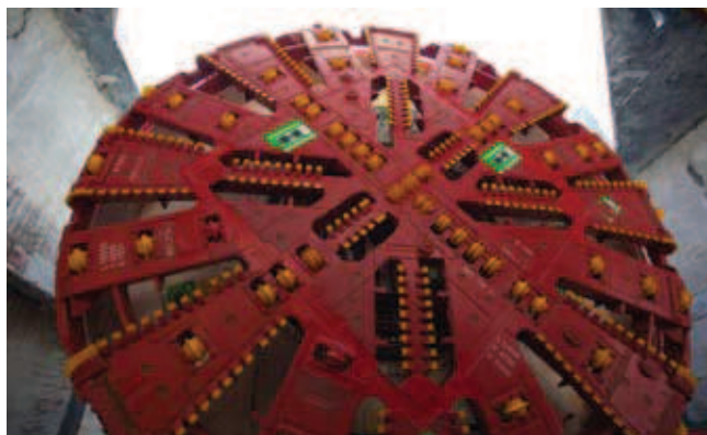
Tarcza maszyny drążącej tunel TBM
