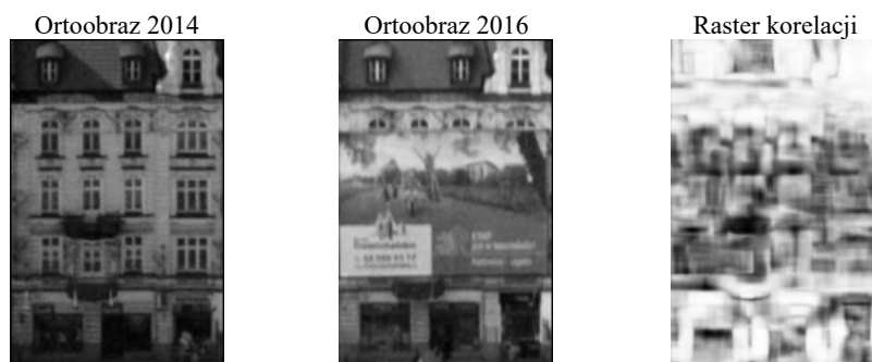
Rys. 6. Przykład reklamy wielkopowierzchniowej, która nie zajmuje całej fasady budynku. Ortoobrazy utworzone przez rzutowanie zdjęć ukośnych z dwóch terminów na tą samą fasadę, wraz z obrazem ilustrującym rozkład przestrzenny współczynnika korelacji.
