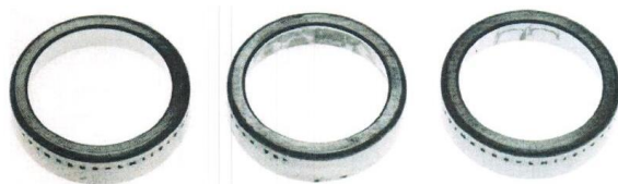
Rys. 5. Widok pierścieni łożysk testowych wg ASTM D 1743 po badaniu w środowisku wody dejonizowanej przy zawartości 0,5 % (m/m) inhibitora korozji typu ABS-Ca (ITWL)
