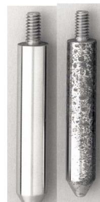
Rys. 4. Widok trzpieni testowych przed i po badaniu właściwości ochronnych oleju bazowego z dodatkiem DNNS-Ca wg PN-ISO 7120 (ITWL)
