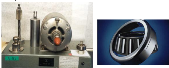
Rys. 1. Widok aparatu do oceny właściwości ochronnych smarów plastycznych wg ASTM D 1743 (ITWL)
