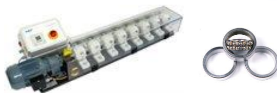
Rys. 2. Widok aparatu do oceny właściwości ochronnych smarów plastycznych w warunkach dynamicznych wg PN-ISO 11007 (ITWL)
