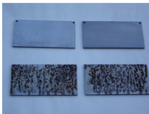
Rys. 3. Widok płytek testowych przed i po badaniu właściwości ochronnych oleju bazowego z dodatkiem DNNS-Zn wg ASTM D 1748 (ITWL)
