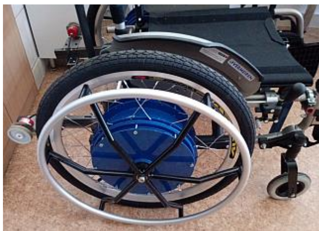
Rys. 19. Kompletny zespół piasty wielobiegowej
