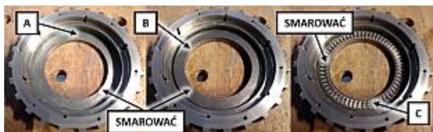
Rys. 12. Montaż łożyska wzdłużnego w zespole koła zewnętrznego
