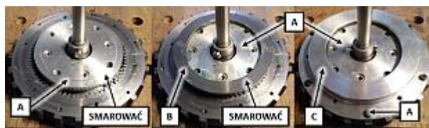
Rys. 16. Montaż drugiego łożyska wzdłużnego
