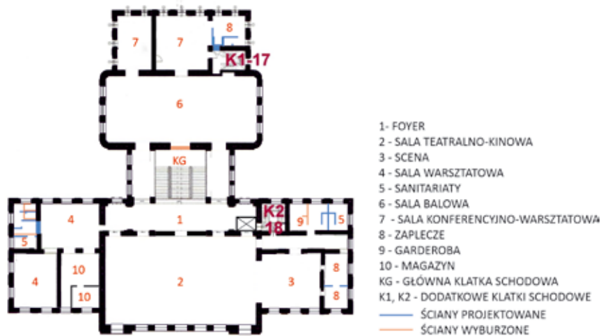
Rys. 2 – Rzut piętra I; źródło: opracowanie własne
