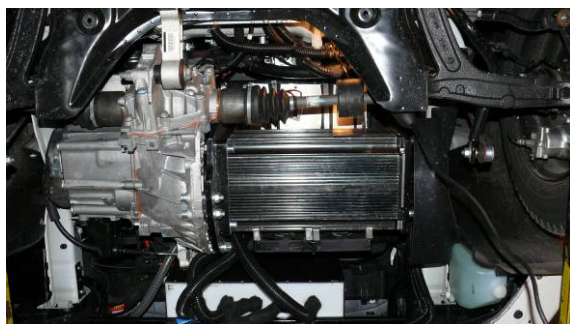
Rys. 3. Napęd pojazdu Fiat Panda 2 z falownikiem IGBT
