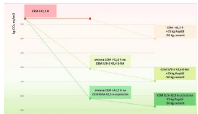
Ryc. 7. Ślad węglowy badanych betonów oraz jego kształtowanie na skutek zmian proporcji i rodzaju spoiwa
