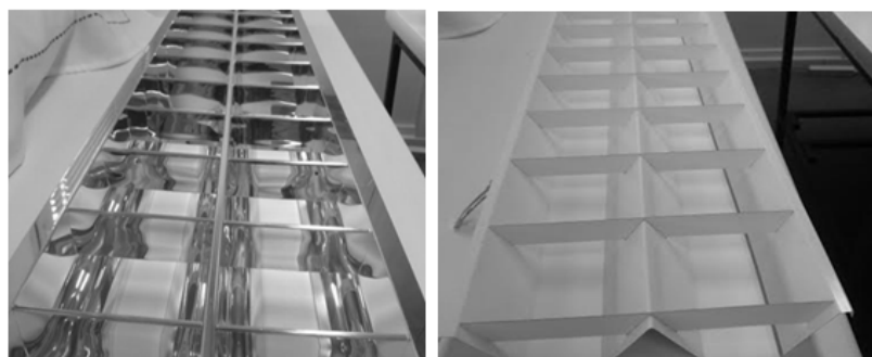
Rys. 1. Wygląd rastrów zastosowanych w oprawie oświetleniowej w trakcie badań po lewej stronie raster nr 1, po prawej – nr 2
