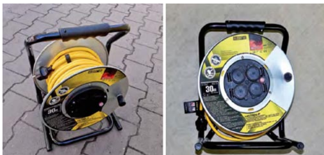
Rys. 3. Przedłużacz przemysłowy przenośny zwijany, wyposażony w zabezpieczenie termiczne [13]
