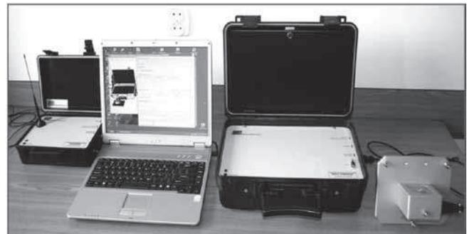
Rys. 3. Kopalniana Stacja Monitoringu Drgań (KSMD) – widok ogólny
