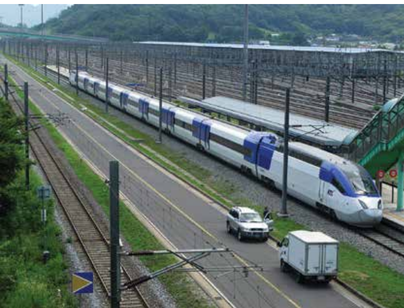
Pociąg dużej prędkości KTX-II (25 kV 60 Hz), Korea Płd. (1.07.2009 r.) fot. G43 / © Wikimedia Commons
