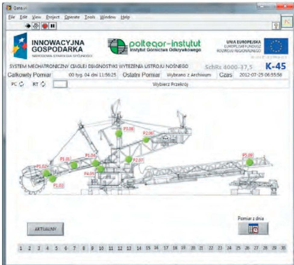
Rys. 8. Koparka SchRs 4000 z zaznaczonymi punktami pomiarowymi Fig. 8. BWE SchRs 4000 with marked measuring points
