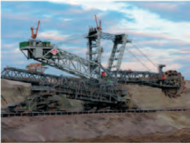
Rys. 1. Konstrukcja nośna koparki SchRs 4000 w KWB Belchatów Fig. 1. The load bearing structure of BWE SchRs 4000 at open cast mine Belchatow
