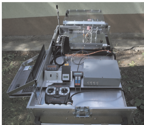
Rys. 2. Prototyp stanowiska z zamontowanym silnikiem JetCat P140 RX (konfiguracja robocza do badań silnika)
