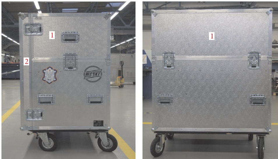
Rys. 6. Widok stanowiska z zamkniętymi osłonami (skrzynia transportowa): 1 — osłona górna, 2 — osłona boczna (przednia)
