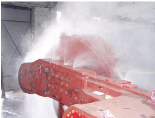
Rys. 19. Powietrzno-wodna instalacja zraszająca kombajnu KSW-460 NE [11, 12]
