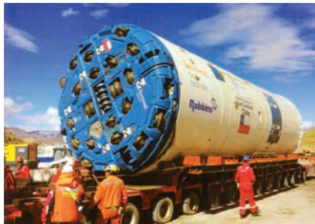
Ryc. 5. Głowica wykorzystana do drążenia tuneli w Andach
