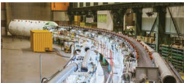
Ryc. 2. Maszyna drążąca EPB-TBM
