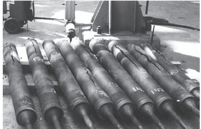
Rys. 2. Pęknięcia wzdłużne rur katalitycznych [13] Fig. 2. Longitudinal cracks of catalytic pipes [13]
