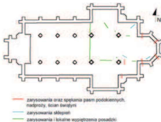
Rys. 6. Uszkodzenia powstałe w wyniku bieżącej eksploatacji górniczej
