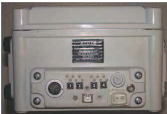
Rys. 3. Panel obsługi modułu termooanemometrycznego 4 x 3D Fig. 3. Control panel of the thermoanemometric module 4x3D
