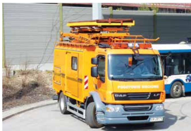
Fot. 18. Pogotowie sieci zmodernizowane w oparciu o podwozie DAF CF55 i wyremontowaną część montersko-wieżową z pojazdu Star 28. Fot. M. Połom
