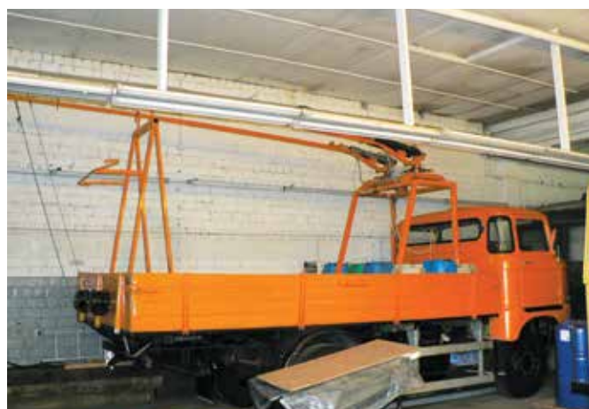
Fot. 12. Pojazd do usuwania oblodzenia sieci trakcyjnej w Eberswalde (Niemcy). Fot. M. Bartłomiejczyk
