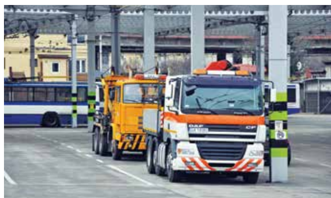
Fot. 23. Dwa pokolenia holowników. Z przodu DAF CF85 z zabudowanym balastem i żurawiem HDS, z tyłu Jelcz C642 z żurawikiem do podnoszenia jednej osi trolejbusów. Fot. K. Grzonka
