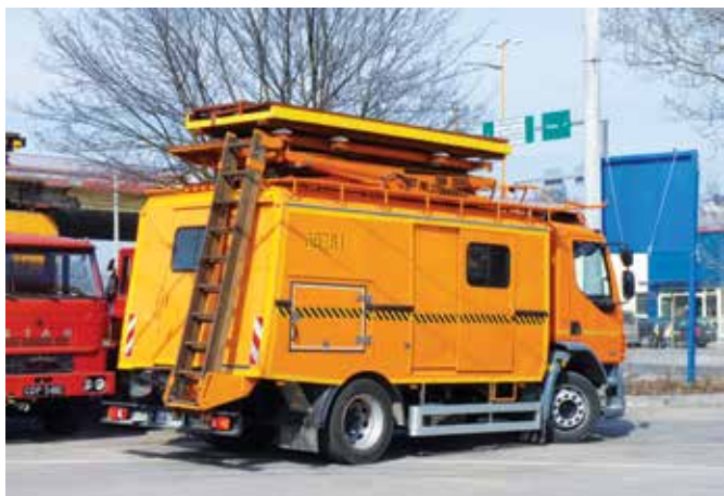
Fot. 19. Pogotowie DAF z widocznymi drzwiami (na poszyciu bocznym pod numerem taborowym), świadectwem modernizacji poprzez zabudowę agregatu spalinowego. Fot. M. Połom
