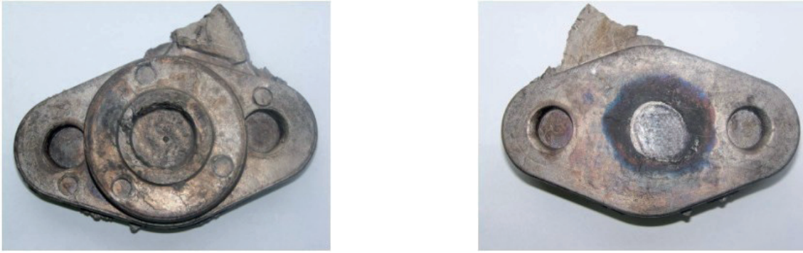
Rys. 1. Zdjęcia ciśnieniowego odlewu z żeliwa białego Fig. 1. Pictures of a white cast iron pressure casting
