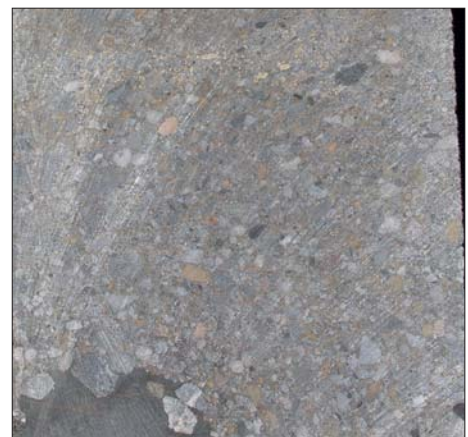
Zlepieniec piaszczysty o malejącym uziarnieniu frakcjonalnym, karbon, namur A, Siciny IG 1. Fot. M.I. Waksmundzka
