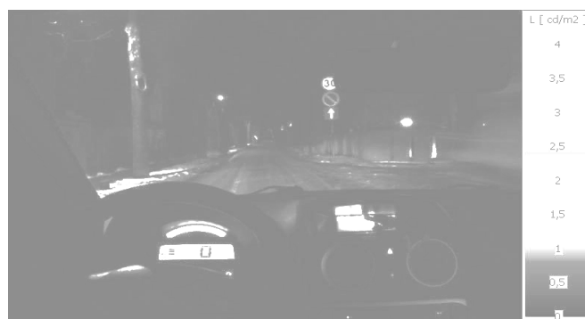
Rys. 12. Obraz drogi bez zastosowania folii polaryzacyjnej
