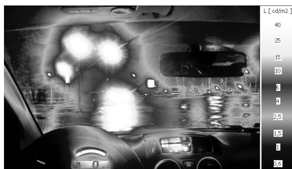
Rys. 8. Obrazy z matrycowego miernika luminancji dla dwóch lokalizacji pomiarowych
