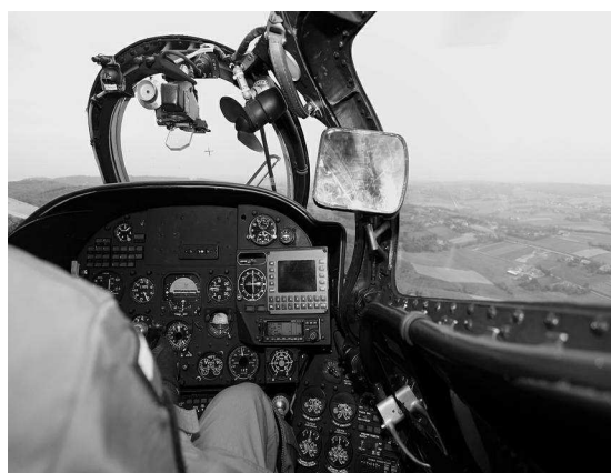
Rys. 2. Widok kabiny górnej ze zintegrowanym systemem łączności na pokładzie śmigłowca Mi-24
