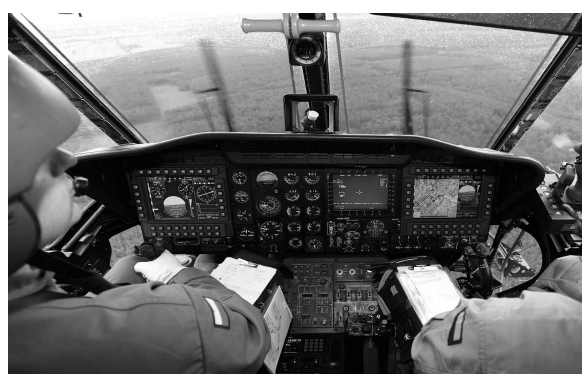
Rys. 4. Widok kabiny ze zintegrowanym systemem łączności na pokładzie śmigłowca W-3PL
