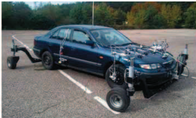
5 pav. Automobilis su sumontuota slydimo sistema ir dinaminių parametru matavimo įranga
