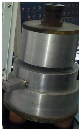
Fot. 4. Aparatura TPMU- a \lambda -20 do określenia przewodności cieplnej i dyfuzyjności niemetalicznych materiałów stałych, od lewej: kontroler, jednostka grzewcza
