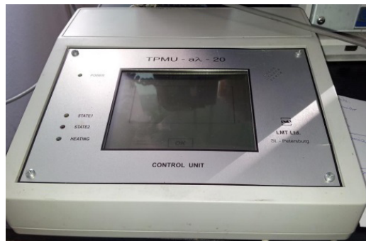
Fot. 4. Aparatura TPMU- a \lambda -20 do określenia przewodności cieplnej i dyfuzyjności niemetalicznych materiałów stałych, od lewej: kontroler, jednostka grzewcza
