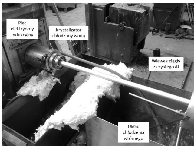
Rys. 4. Widok procesu poziomego odlewania ciągłego Al o czystości 99,5%
