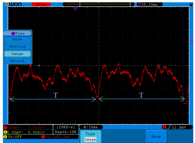
Rys. 6. Zrzut ekranu oscyloskopu, przedstawiający dwa obroty wału[3].
