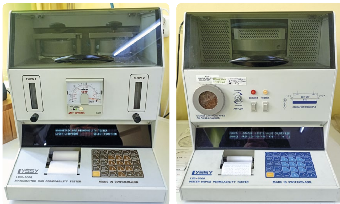
Fot. 4. Aparaty dostępne w Laboratorium Badawczym „Polimer” w Łukasiewicz – IMPiB A – urządzenie do oznaczania przenikalności azotu N_2 Lyssy L100 – 5000 B – urządzenie do oznaczania przenikalności pary wodnej H_2O Lyssy L80 – 5000
