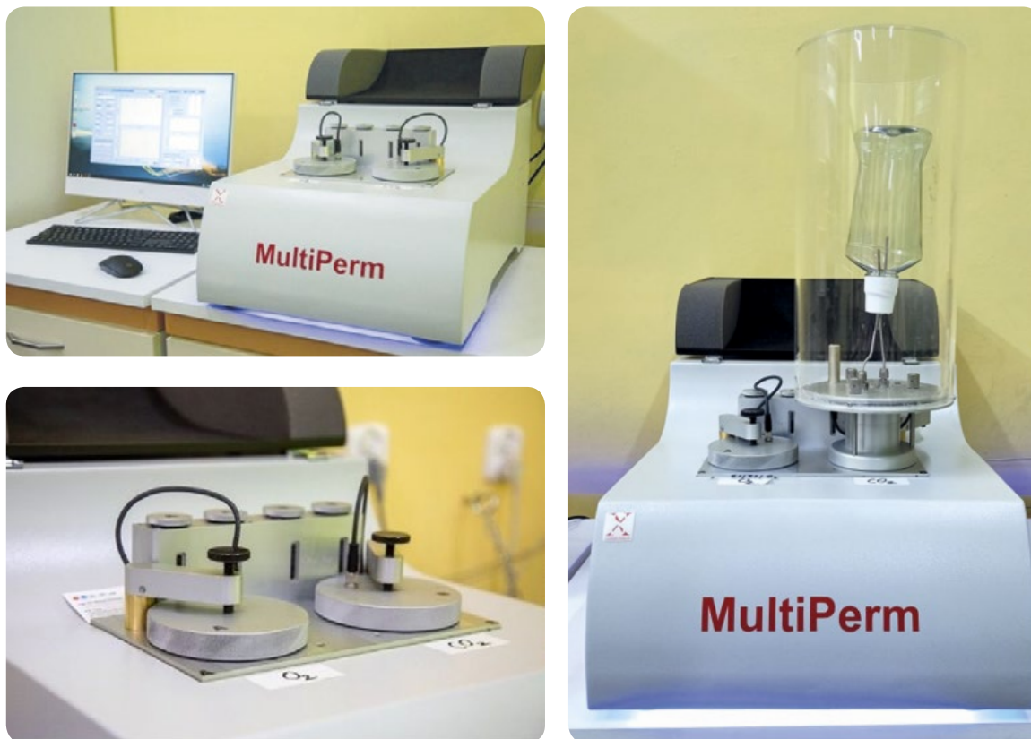
Fot. 3. Urządzenie do oznaczania przenikalności gazów ( O_2 i CO_2 ) XSDS/Pro MultiPerm O_2 - CO_2 DC firmy ExtraSolution znajdujący się w Laboratorium Badawczym „Polimer” w Łukasiewicz – IMPiB
