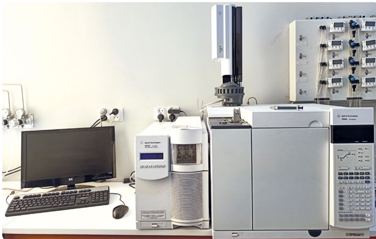
Fot. 2. Aparat do analizy mieszaniny gazu wewnątrz opakowań GC – MS Agilent Technologies z Laboratorium Badawczego „Polimer” w Łukasiewicz – IMPiB
