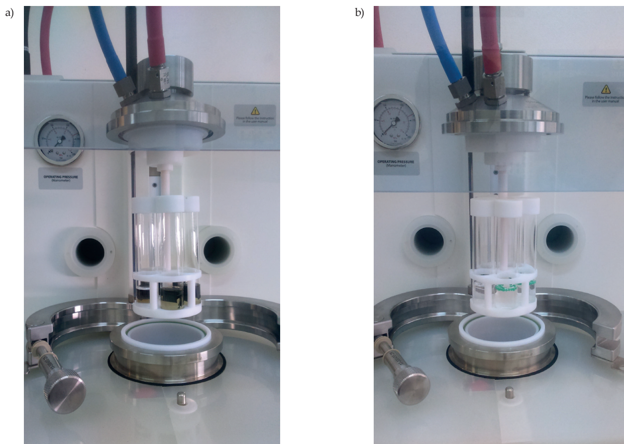
Rys. 1. Próbkę: a) separatora polimerowego, b) materiału odniesienia PE-LD (ERM-EC681m) przed mineralizacją mikrofalową w aparacie UltraWAVE, Milestone
