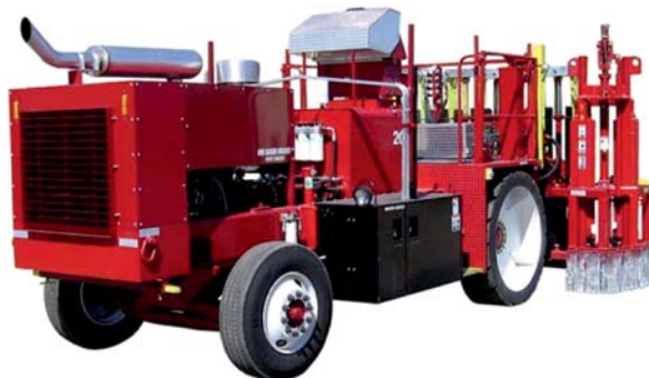
Fot. 21. Typowy, wielogłowicowy, samojezdny łamacz do betonu MHB [14]
