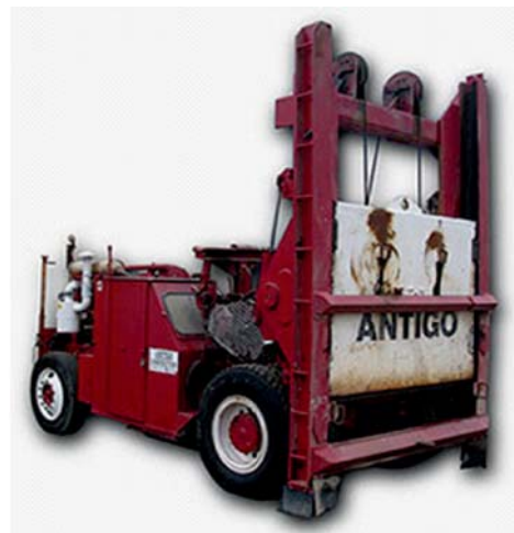
Fot. 1. Samojezdny gilotynowy łamacz do betonu Wirtgen CB7000 [14]
