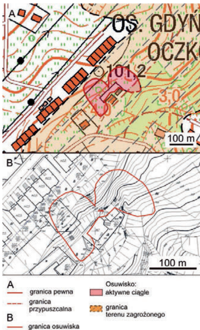
Rys. 5. Figura ilustrująca różnice w dokładności lokalizowania granic osuwiska na mapach w różnej skali. A – mapa w skali 1:10 000; B – mapa zasadnicza (dane Urzędu Miejskiego w Gdyni)
