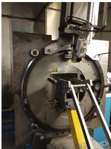
Rys. 11. Stanowisko kształtowania z podgrzewaniem laserowym [5, 9]
