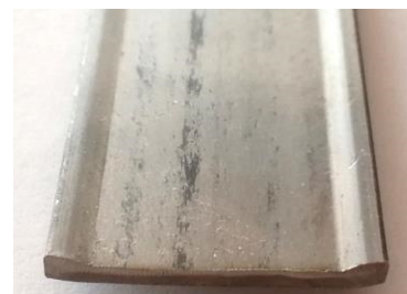
Rys. 10. Krata pomostowa (z lewej) oraz profil o zmiennym przekroju (z prawej) [8]
