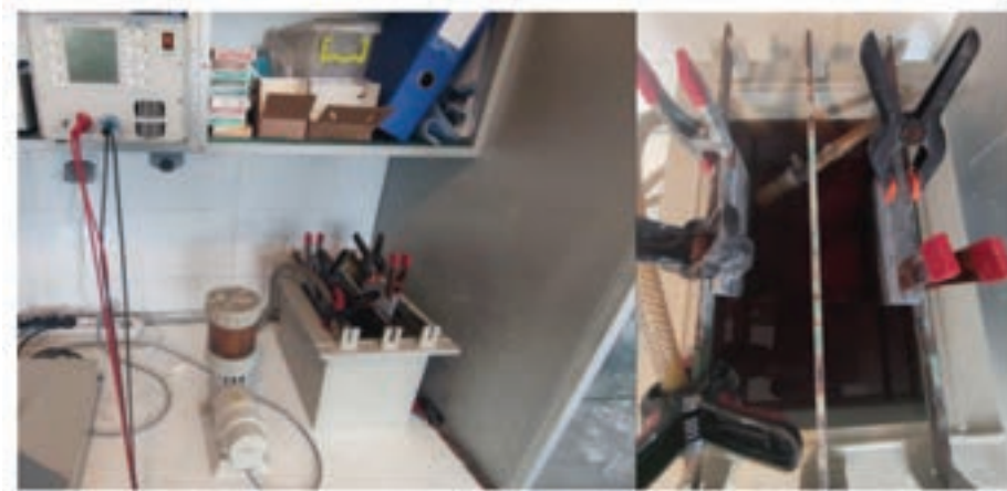
Fig. 1. Test stand for deposition of zinc coatings Rys. 1. Stanowisko badawcze do osadzania powłok cynkowych
