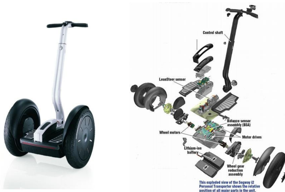
Rys. 1. Segway i2 a) poprawiona wersja, wypuszczona na rynek w 2006 roku [7], b) rozstrzał elementów w pojeździe Segway [8]
