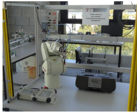
Rys. 4. Stanowisko laboratoryjne do programowania oraz symulacji pracy robota Kawasaki RS003N.
